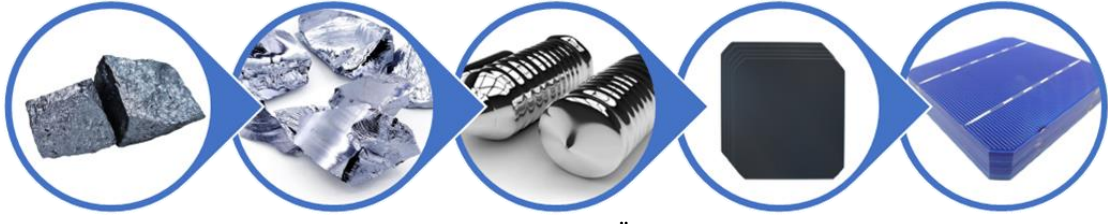
Resim 1: k-Si FV Hücre Üretim Süreci
