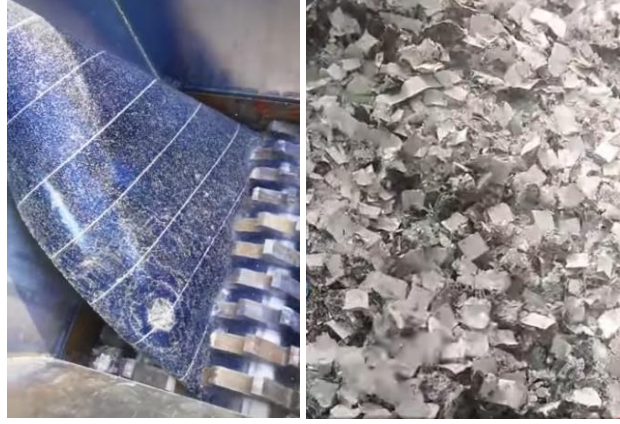
Resim 6: FV Panelin Öğütülmesi ve Öğütme Sonucu Elde Edilen Malzeme ( https://www.youtube.com/shorts/WmMp5w8R_zl )
